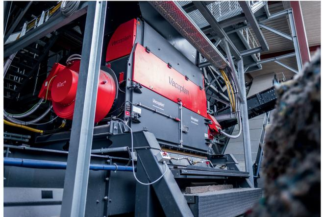
Für die Nachzerkleinerung wurde der VEZ 2500 TT installiert. Der Schredder ist mit einem Hochleistungsschneidwerk auf maximalen Durchsatz ausgelegt. © Vecoplan
