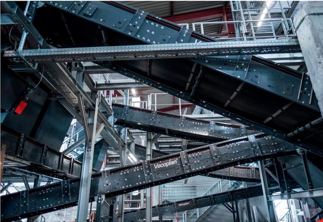
Der Anlagenhersteller lieferte die gesamte Fördertechnik: Muldenförderbänder, Pendelverteiler, Kratzkettenförderer und Doppelförderschnecke.
