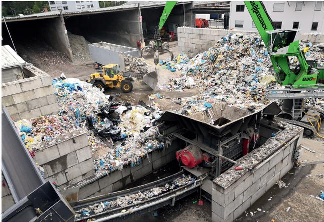
Das Input-Material hat eine Schüttdichte von etwa 200 bis 250, der Produktionsabfall 120 bis 180 Kilogramm pro Kubikmeter. Mitarbeiter sortieren das Material mit Greiferbaggern und Radladern grob vor und geben es in die Vorzerkleinerung. © Vecoplan
